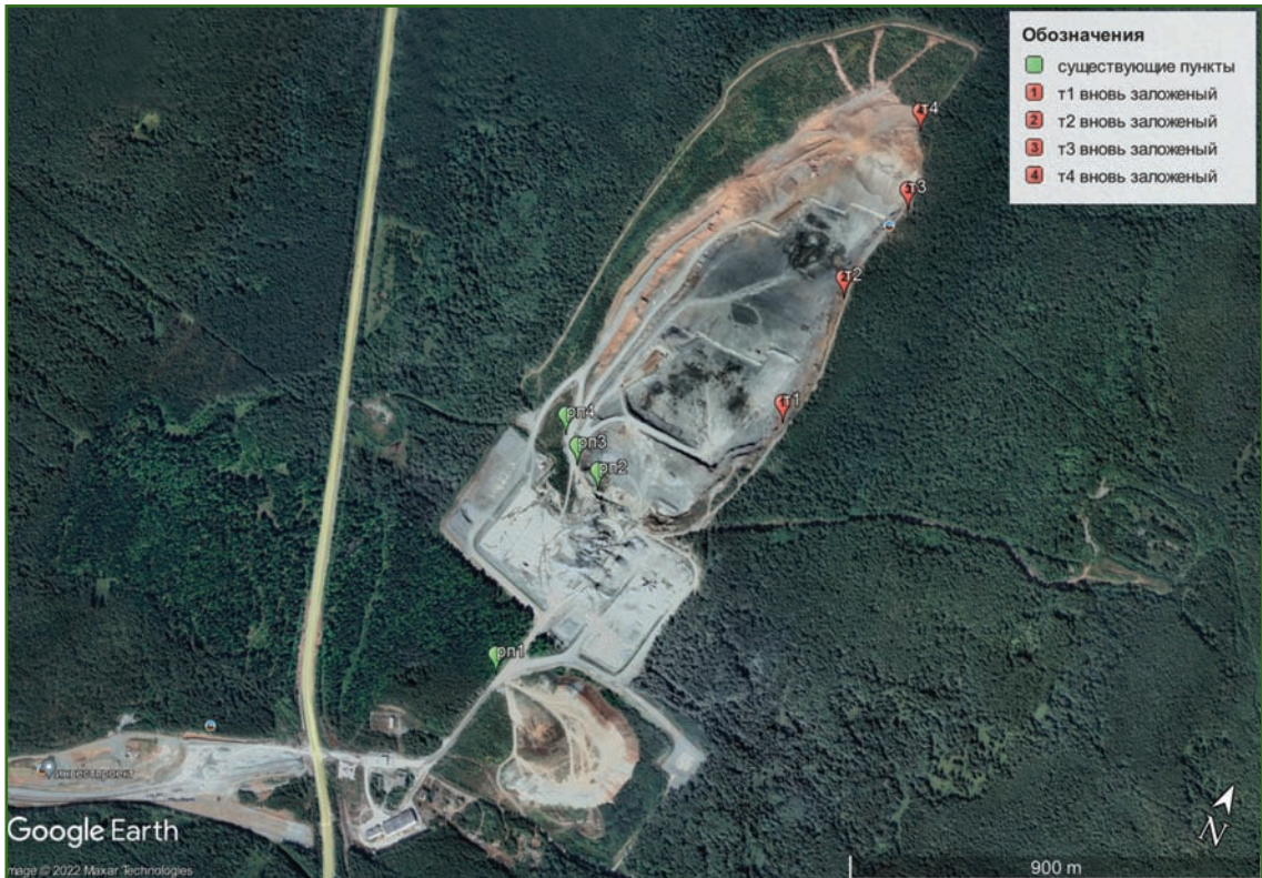
Рис. 2 Схема расположения пунктов опорной маркшейдерской сети на карьере «Гора Змеёвая»
